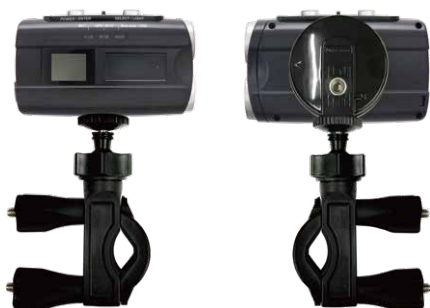
三脚ブラケットとハンドルアダプタを使用して自 転車、バイクのハンドルバーのほか、柱状(約 17mm から約 32mm)にも取付出来ます。
