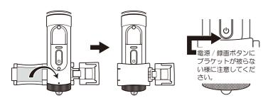
2. ブラケットのロックレバーを倒して固定して下さい。
